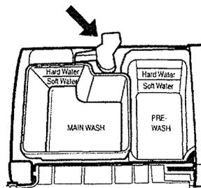
2. Verser la quantité adaptée de détergent dans la section de lavage principal du distributeur en vous référant au tableau ci-dessous. En cas d'utilisation de détergent en pastilles, celles-ci doivent être placées dans la section de lavage principal. (Voir "Quantité de détergent à utiliser".)
