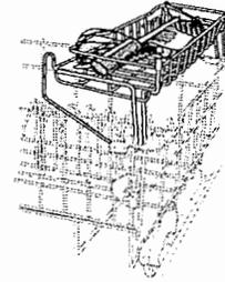
Le panier à ustensiles repose sur les deux supports du côté droit du panier inférieur. Charger le panier à même le lave-vaisselle ou le sortir pour le charger sur un comptoir ou une table.
