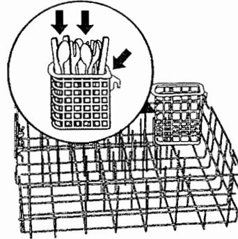
Le porte-ustensiles comporte trois crochets. (Voir les flèches.) Pour la meilleure performance de lavage, accrocher le porte-ustensiles dans le coin arrière droit du panier inférieur. On peut aussi l'accrocher dans le coin avant gauche.
